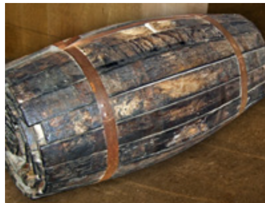
Costillas de barriles desarmados para armar barriles de aceite, tal como se transportaban hasta su uso.
