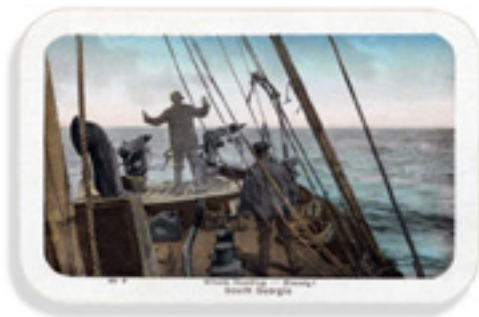
Cañón con arpón explosivo utilizado en la proa de los barcos cazadores. Foto coloreada de una antigua postal de un cazador en las Georgias del Sur.
